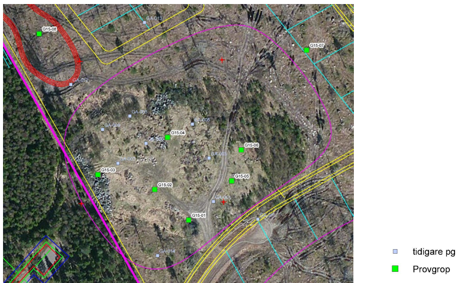
Figur 20: Översikt provgropar. Visar provgropar av Geosigma och Golder. Kartan är schematisk och gjord på en äldre version av strukturförslaget (Geosigma).
