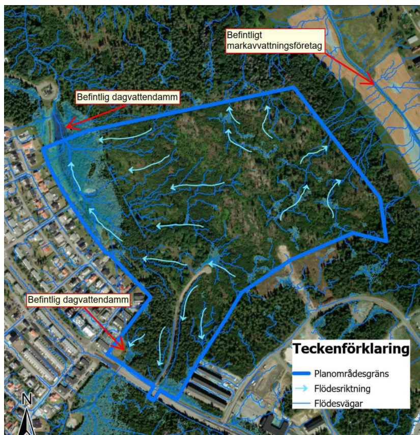
Figur 19: Avrinning och lågpunkter inom och i anslutning till planområdet utifrån befintliga höjder. Utredningsområde redovisas med blå linje. (Sweco)
