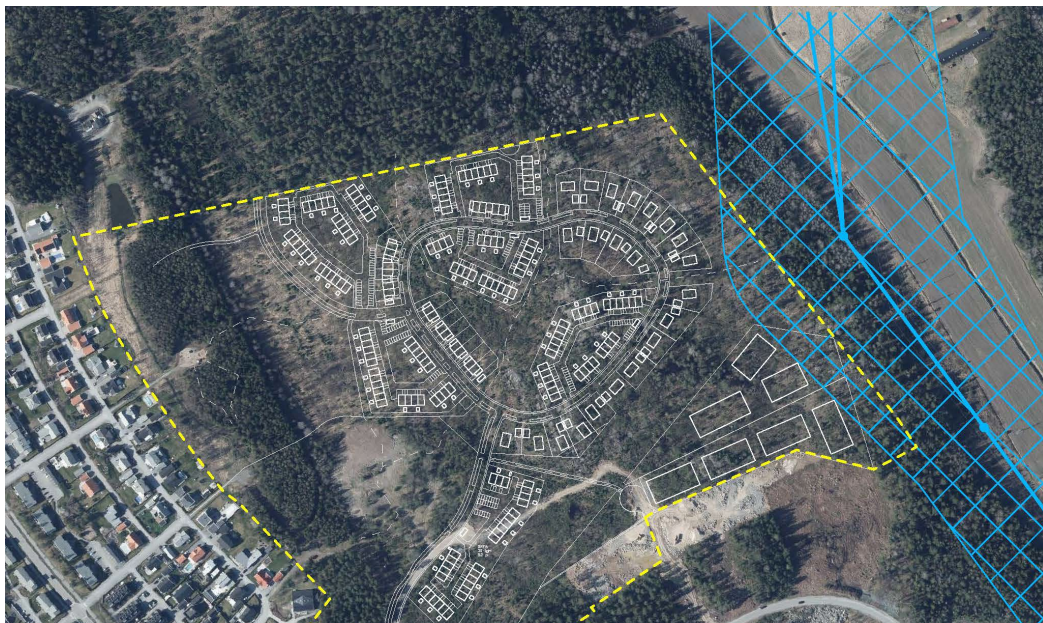
Figur 27: Illustration av maximal utbredning av område med magnetfält som överstiger 0,4 \mu T från kraftledningen (blårutigt område). Illustrerat avstånd är 120 meter och gäller vid vinkelstolpar. Från själva kraftledningen (rak sträckning) är 85 meter ett maxvärde. (Väv Arkitekter)
